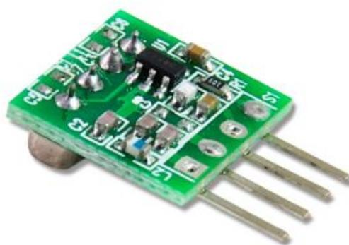
拥有高输出功率(3V/+10dBm)，与出色的传输效能(50Kbps)。该产品可广泛应用于车用遥控芯片锁、免钥匙开门系统、无线家庭保全、无线遥控系统及无线感应相关产品。
